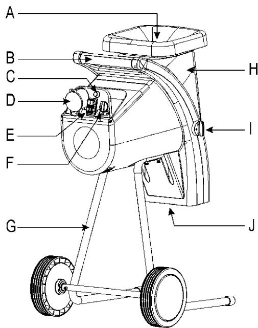
A. Otvor lijevka za materijal za sječenje
